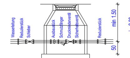
ANSCHLUSS EINES UNTERFLURHYDRANTEN
