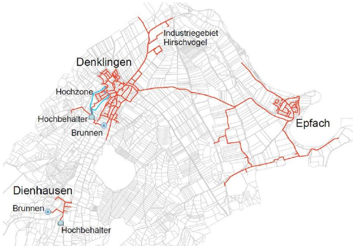
Abbildung: Übersicht der derzeitigen Wasserversorgung Dienhausen-Denklingen-Epfach
