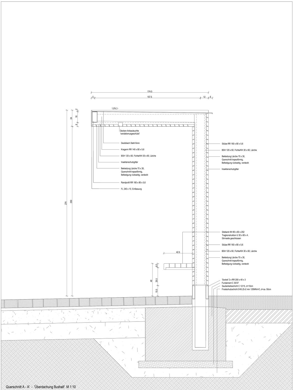
Querschnitt A - A' - 'Überdachung Bushalt' M 1:10
