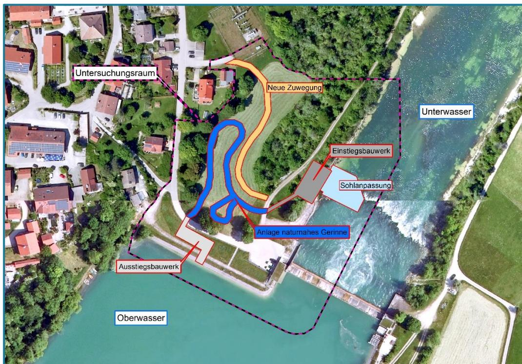
**Abbildung 2: Übersicht der geplanten Maßnahmen zum Neubau der Fischaufstiegsanlage Epfach auf Grundlage der technischen Vorplanung. Der Untersuchungsraum wurde entsprechend den zu erwartenden, vorhabenbedingten Wirkungen abgegrenzt.**
