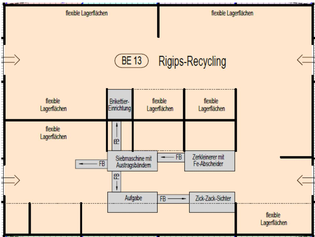
Innerhalb der Halle soll die Aufstellung der Maschinen dahingehend variiert werden können, dass die Brikettiereinrichtung auch direkt neben der Siebmaschine aufgestellt werden kann. Eventuell soll eine weitere Fördereinrichtung installiert werden, welche das Überkorn (siehe Verfahrensbeschreibung) direkt wieder in den Zerkleinerer fördern soll.
