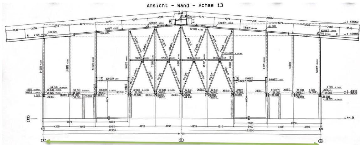
Die Abstände der Träger (grün) an den Stirnseiten der Halle haben unterschiedliche Breiten und durch die Dachschräge verschiedene Höhen: von 4,255 m und 4,165 m außen über 5,460 m an den Toren sowie in der Mitte jeweils 4,235m
