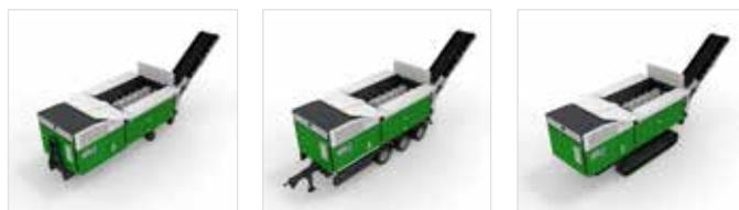
Beim mobilen Crambo hat man die Wahl: Hakenliftversion (Hook), Drei-Achs-Zentralanhänger (Trailer) oder Raupenfahrwerk (Track). In der Hakenliftversion verleiht die Schleppvorrichtung Beweglichkeit am Platz. Komfortabel in Bezug auf die Mobilität ist die Trailer-Variante mit luftgedephten Achsen und einer Vorfahreinrichtung. Das Raupenfahrwerk mit zwei-stufigem Fahrtrieb und extrabreiten Bodenplatten macht auch unbefestigtes Gelände befahrbar.
